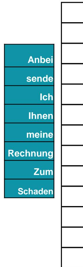
Input Layer – Für jedes Wort eine separate Eingabe. „One-hot-encoding“
